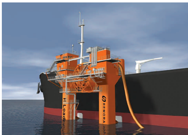
Remoras HiLoad DP koblet til et tankskip, klargjort for lasting av olje.
